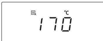
Духовой шкаф начинает предварительный прогрев, во время которого на дисплее отображается значок . Предварительный прогрев завершается, когда температура внутри духового шкафа достигает заданного значения. Предварительный прогрев духового шкафа рекомендуется выполнять во всех режимах приготовления, кроме отдельных случаев, указанных в руководстве по приготовлению.
