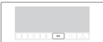
3. Нажмите **OK**, чтобы начать процесс очистки. Очистка паром выполняется в течение 26 минут.
