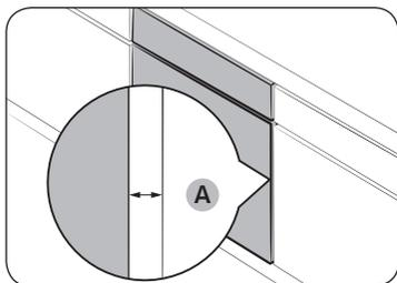
Оставьте зазор (A) не менее 5 мм между духовым шкафом и каждой из стенок отсека.
