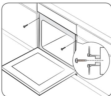
Установите духовой шкаф в отсек кухонной мебели и надежно закрепите его с обеих сторон 2 винтами.
