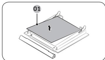
2. Снимите крышку, затем снимите стекла 1 и 2 с дверцы.
