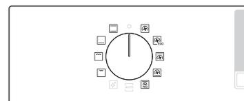
1. Поверните переключатель режима для выбора режима или функции. На дисплее отобразится температура, заданная по умолчанию для выбранного режима или функции.
