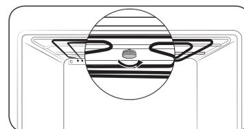
1. Нагревательный элемент гриля можно опустить, чтобы было удобнее очищать верхнюю стенку камеры духового шкафа. Отверните круглую гайку, вращая ее против часовой стрелки и придерживая нагревательный элемент гриля.
