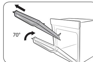
2. Прикройте дверцу на угол примерно 70°. Двумя руками возьмитесь посередине за обе стороны дверцы и тяните дверцу на себя и вверх до тех пор, пока петли полностью не выйдут из отверстий.
