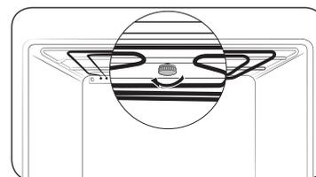
3. После завершения очистки поднимите нагревательный элемент гриля в исходное положение и заверните гайку в направлении по часовой стрелке.
