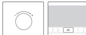
1. Пока цифры часов мигают, поворотом переключателя значений (правый переключатель) установите значение часов, а затем нажмите **OK** для перехода к установке значения минут.
