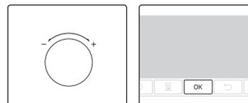
2. С помощью переключателя значений установите нужную продолжительность работы, а затем нажмите **OK**. Максимальное значение времени, доступное для установки: 23 часа 59 минут.
