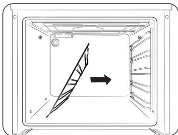
3. Потяните и извлеките боковую направляющую из двух отверстий в нижней части стенки камеры.
