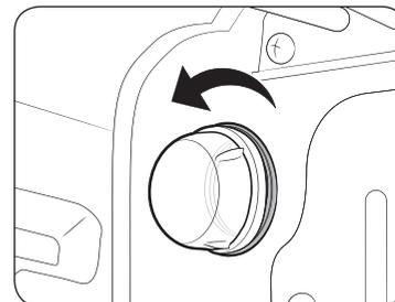
1. Снимите стеклянный колпачок, повернув его против часовой стрелки.
