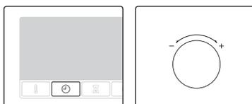
2. Нажмите кнопку
