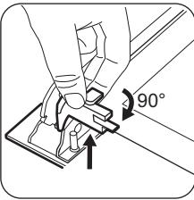
**6** Поверните два фиксатора на 90° и извлеките их из своих гнезд.
