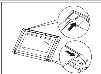
Закінчивши процедуру чищення, встановіть скляну панель і дверцята на місце. Виконайте описані вище дії у зворотній послідовності. Зона з трафаретним друком повинна бути повернута до внутрішньої сторони дверцята. Після встановлення переконайтесь, що поверхня рамки скляної панелі в області трафаретного друку не шорстка на дотик. Упевніться, що внутрішня скляна панель правильно вставлена на місце. Див. малюнок.
