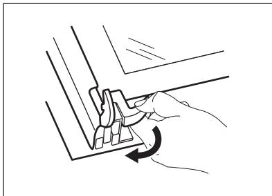
6. Поверніть два фіксатори на 90° і вийміть їх із гнізд.
