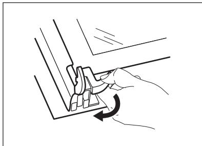
5. Отожмите стопоры, чтобы снять внутреннюю стеклянную панель.
