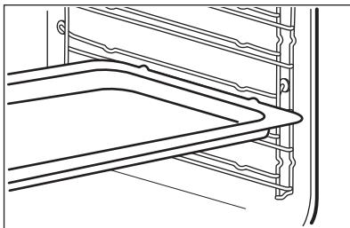
Одновременная установка решетки и глубокого противня:
