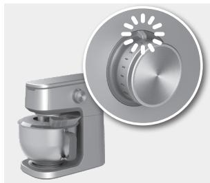
**9. Uwaga:** Jeśli pokrętło wyboru prędkości zostało już ustawione w pozycji roboczej przed podłączeniem urządzenia do zasilania, podświetlenie pokrętła zacznie migać, sygnaлизując, że urządzenie jest nadal włączone. Po obróceniu pokrętła wyboru prędkości do położenia wyłączenia po upływie 3 minut oświetlenie robocze i kontrolka zgasną. Następnie powróci one do normalnego działania.
