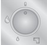
В соответствии с каждой ручкой указана соответствующая ей конфорка (пример на рисунке сбоку соответствует передней левой конфорке).
