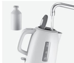
4. **Odvápnění** je doporučováno provádět pravidelně podle tvrdosti vody. Naplňte konvici vodou a prostředkem na odstranění vodního kamene podle pokynů na štítku daného čisticího prostředku. Směs nevařte, mohla by vypřenit. Poté konvici důkladně propláchněte čistou vodou.
