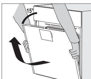
**3** Медленно закрывайте дверцу, пока фиксаторы не упрутся в прорези на дверце. Приблизительно при 15° (относительно открытой дверцы) дверцу немного приподнимите и извлеките из гнезд шарниров.
