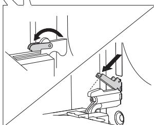
**2** **A** Откиньте фиксаторы до конца назад (при обычном закрывании дверцы).
