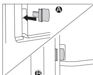
При установке полностью выдвигающихся телескопических направляющих с вкладышами EasyClean установите фиксаторы (прилагаются в комплекте) в отверстия в нижней части боковых стенок духовки. Зашелкните направляющие в фиксаторах.
