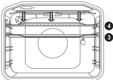
При **большом гриле** включаются верхний нагревательный элемент и инфранагреватель, расположенные под потолком духовки.
