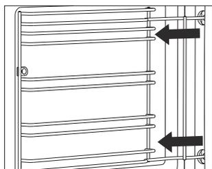
**2** Извлеките направляющие из отверстий в задней стенке.
