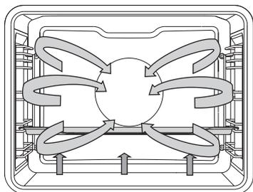
Одновременно работают нижний нагревательный элемент, нагревательный элемент вокруг вентилятора и вентилятор.
