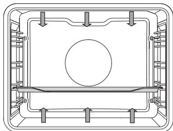
Верхний и нижний нагревательные элементы равномерно излучают тепло внутрь духовки.
