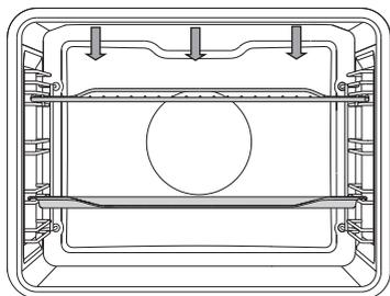
При **большом гриле** включаются верхний нагревательный элемент и инфранигреватель, расположенные под потолком духовки.
