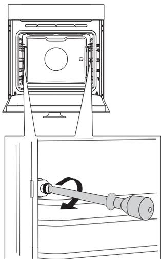
**1** Открутите винт с помощью отвертки.
