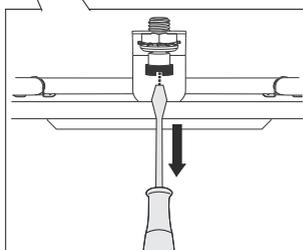
**1** Чтобы освободить верхние нагреватели, открутите винт в передней части потолка духовки.
