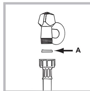
1. Вставьте прокладку А в конец заливного шланга и наверните его на вывод водопровода холодной воды с резьбовым отверстием 3/4 дюйма (см. рис.). Перед подсоединением
