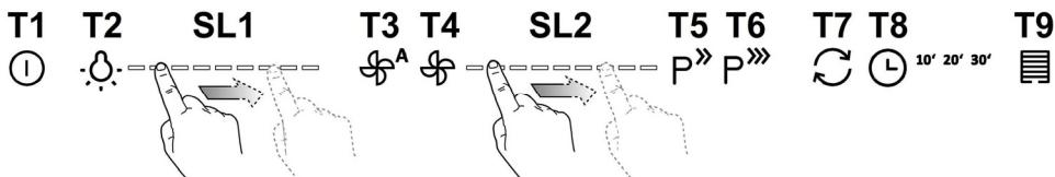
Per te seleksionuar funksionet e aspiratorit eshte e mjaftueshme te preken butonat.
