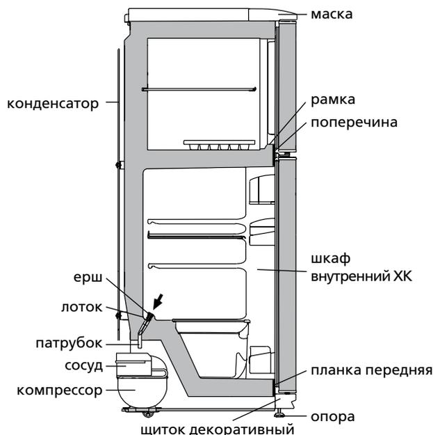
Рисунок 4 — Схема слива талой воды из ХК
