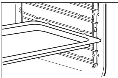
Одновременная установка решетки и глубокого противня:
