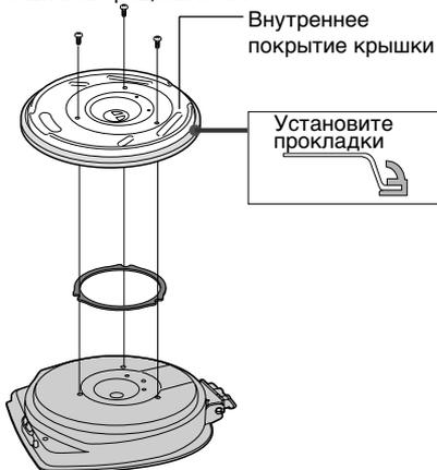
Снимите крышку, отвинтите 3 самореза и снимите с крышки внутреннее покрытие. Замените резиновые прокладки, а затем поместите на место внутреннее покрытие крышки и зафиксируйте ее саморезами.
