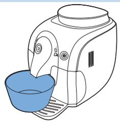
В процессе нагрева вода течет по внутреннему контуру, нагревая кофемашину. Этот процесс занимает несколько секунд.
