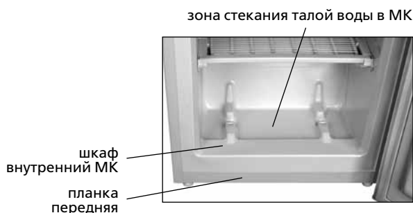
Рисунок 7 — Сбор талой воды из МК
