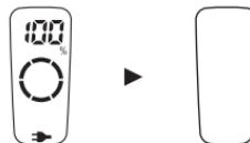
Индикатор ёмкости аккумулятора и ➡ загорятся, а затем погаснут через 5 секунд.
