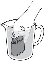
**3** Вставьте фильтр AquaClean в вертикальном положении в соответствующий разъем. Нажмите на фильтр AquaClean, чтобы он опустился вниз до упора. Для обеспечения оптимальной работы убедитесь, что фильтр плотно зафиксирован, а уплотнительный слой находится в правильном положении.
