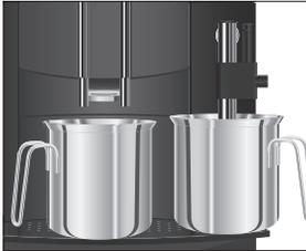
**i** Промывку фильтра можно остановить в любой момент. Для этого поверните поворотный переключатель режимов приготовления горячей воды и пара в исходное положение. Для продолжения процесса промывки фильтра поверните поворотный переключатель режимов приготовления горячей воды и пара в соответствующее положение.
