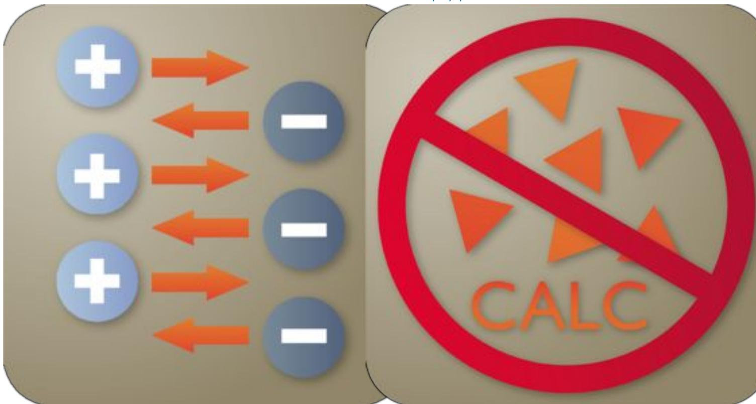
Благодаря технологии ионного обмена из воды, поступающей в кофемашину, удаляется кальций, что препятствует его накоплению внутри прибора. Заменяйте фильтр раз в три месяца, чтобы поддерживать прибор в идеальном состоянии и забыть о выполнении очистки от накипи на протяжении приготовления 5000 чашек напитка.
