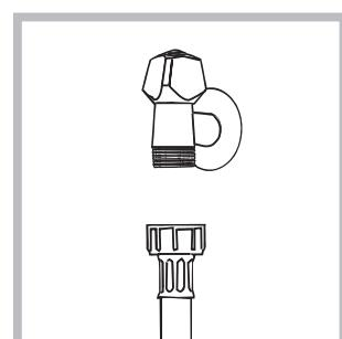
1. Прикрутите шланг подачи к крану холодной воды с резьбовым отверстием 3/4 gas (см. схему). Перед подсоединением откройте водопроводный кран до тех пор, пока из него не потечет чистая вода.
