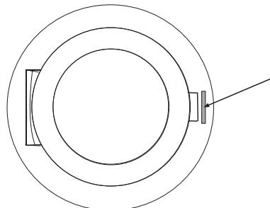
После использования установите шпатель для принудительного открывания дверцы С на место В (см. рис. в разделе «Дозатор»).
