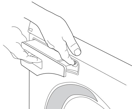
После того как предохранительная защелка, не допускающая открытие отсека детьми, будет активирована, необходимо нажать открывющую кнопку, чтобы выдвинуть отделение для моющего средства.
