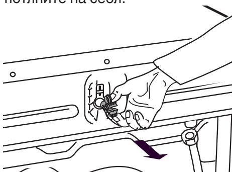
3. Снимите пластмассовые заглушки с пробок. Вставьте их в отверстия, где находились пробки. Сохраните
