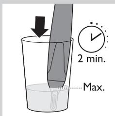
*Совет. Для очищения режущего блока рекомендуется погрузить его в емкость с теплой водой на несколько минут. Затем следует включить прибор.*
