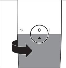
**5** Поверните крышку отсека для батареи против часовой стрелки так, чтобы указатель установки оказался в положении “выключено” (0).
