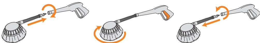
Плотно вставьте вращающуюся щетку в пистолет и поверните ее по часовой стрелке, чтобы зафиксировать в нужном положении.
