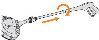
Вставьте удлинительную трубку в пистолет, плотно нажмите и поверните ее по часовой стрелке, чтобы зафиксировать.
