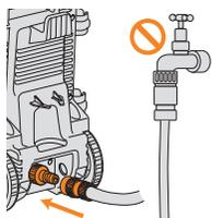
Убедитесь, что не осуществляется подача воды. Плотнo вставьте шланг подачи воды с соответствующим разъемом во впускное отверстие, чтобы зафиксировать его в нужном положении.
