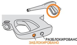
Предохранитель спускового механизма находится под рукояткой. Перед подсоединением напорного шланга к пистолету или его отсоединением предохранитель всегда должен находиться в **ЗАБЛОКИРОВАННОМ** положении.
