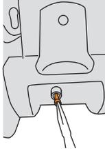
Для того чтобы снять фильтр для воды, отогните лапку внутреннего фильтра для воды с помощью плоскогубцев и осторожно вытяните фильтр.
