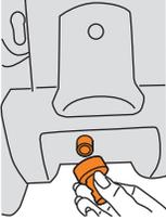
Для того чтобы получить доступ к фильтру для воды, выкрутите и снимите впускной разъем.
