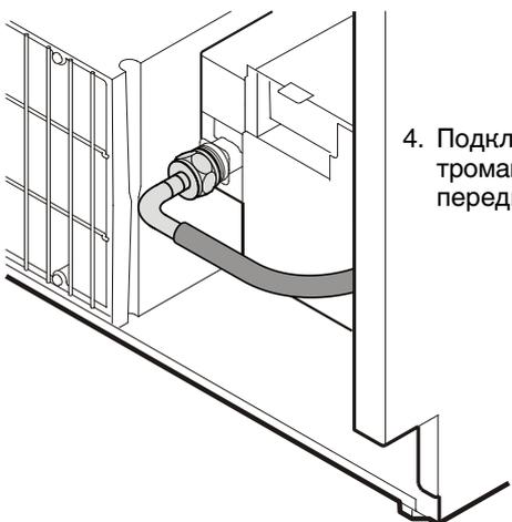
4. Подключите шланг к электромагнитному клапану на передней стенке прибора.
