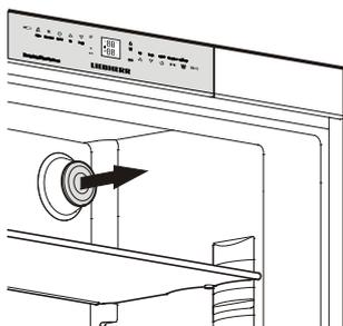
2. Вставьте фильтр для воды и поверните его на 90° по часовой стрелке.
