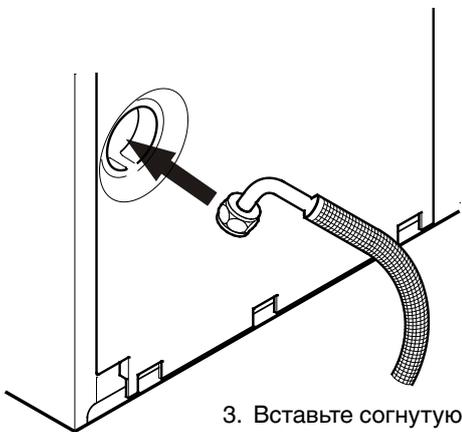
3. Вставьте согнутую под углом часть шланга через отверстие в задней стенке прибора.
