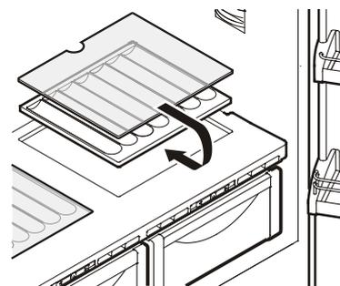
Углубления в полке обеспечивают безопасное хранение бутылок.
