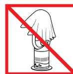
Чтобы избежать перегрева и опасности пожара, не накрывайте обогреватель.
