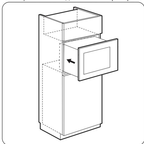
4. Откройте дверцу и закрепите микроволновую печь внутри мебели при помощи самореза.
