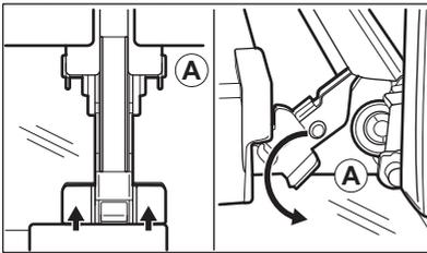
3. Прикройте дверцу до первого фиксируемого положения (приблизительно на угол 70°).
