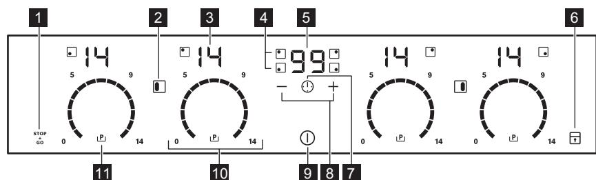
Управление прибором осуществляется с помощью сенсорных полей. Работа функций подтверждается выводом информации на дисплей, а также визуальной и звуковой индикацией.
