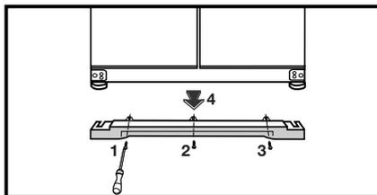
2. После того, как процесс балансировки завершен, установите вентиляционную крышку на место и закрепите ее винтами.
