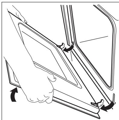
6. Прикройте дверцу до первого фиксируемого положения (наполовину). Затем вытяните дверцу вперед из ее гнезда.
