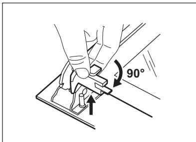
9. Поверните два фиксатора на 90° и извлеките их из своих гнезд.
