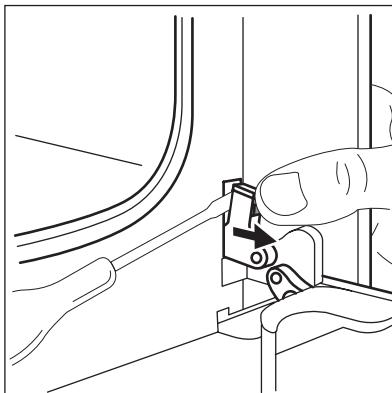
3. Удерживайте нажатый фиксатор одной рукой. С помощью отвертки другой рукой поднимите и поверните рычажок правой петли.
