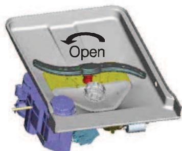
ШАГ 1. Поверните против часовой стрелки фильтр грубой очистки, вытащите его по направлению вверх
