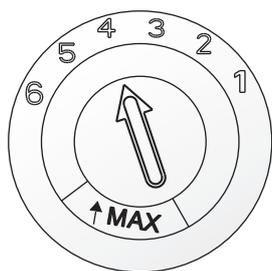
Определенное количество ополаскивающей жидкости используется во время последнего полоскания. Как и в случае с моющим средством, количество средства для полоскания зависит от жесткости воды. Слишком много средства приведет к чрезмерному образованию пены и разводам на Вашей посуде. Если вода в Вашем районе мягкая, Вам не нужно средство для полоскания. Если же нужно, то Вы можете разбавить его соответствующим количеством воды.
