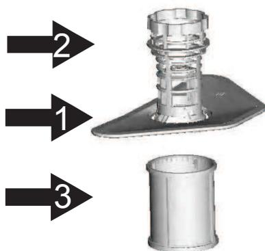
Система фильтрации состоит из фильтра грубой очистки, основного фильтра и фильтра тонкой очистки
