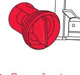
**3** Промойте фильтр под проточной водой и установите на место.
