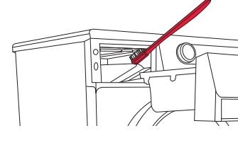
**2** Очистите отсек дозатора, особенно форсунки в верхней части отсека, щеткой.
