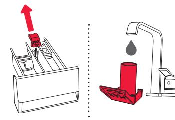
**3** При необходимости снимите и очистите колпачок дозатора.
