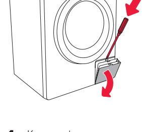
**1** Крышку фильтра можно открыть с помощью плоской отвертки или подобного инструмента.
