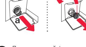
**2** Перед очисткой фильтра извлеките сливную трубку (а).
