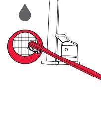
**2** Тщательно промойте фильтр под проточной водой.
