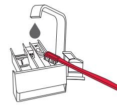
**2** Очистите дозатор щеткой под проточной водой, затем высушите его.
