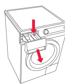
**1** Дозатор можно полностью извлечь из корпуса, нажав на язычок.
