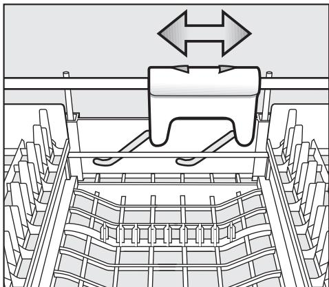
Чтобы получить больше места в выдвижном поддоне для больших столовых приборов, Вы можете эту часть переставить выше с помощью желтого фиксатора.
