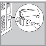
1. Отверните винт V и откройте крышку клеммника (см. *puc*.).
