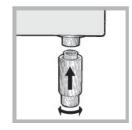
Плита комплектуется надставными опорами, которые устанавливаются в отверстия под основанием плиты.\*
