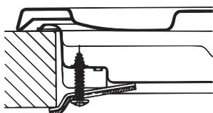
Монтаж крюка для опорных брусков  $H=40\text{mm}$
