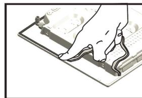
Установите прилагающиеся уплотнения по внешнему периметру варочной панели во избежание попадания воздуха, влаги и воды (см. схему).
