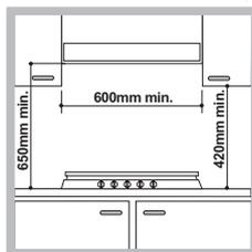
Если варочная панель устанавливается под навесным шкафом, последний должен располагаться на высоте не менее 700 мм от кухонного топа.
