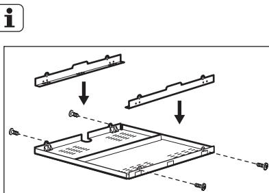
В случае использования защитного короба (дополнительная принадлежность<sup>1)</sup>), фронтальный 2-мм вентиляционный зазор и защита пола под прибором не являются обязательными.
