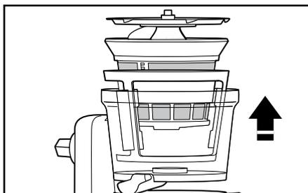
**1 Для отсоединения:** Снимите крышку. Снимите шнек. Выньте из чаши фильтр и корзинку для очищения фильтра/ чаши соковыжималки и отсоедините их друг от друга. Отсоедините желоб для мякоти.
