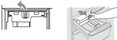
2. Затем нужно перевернуть льдогенератор, затем вытянуть белую поворотную ручку, затем можно снять ящик льдогенератора.
