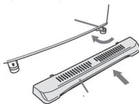
Поверхность пола должна быть ровная. В случае если поверхность пола не ровная, при работе холодильника может возникнуть лишняя вибрация и посторонние звуки. Также если холодильник установлен на пол с использованием деревянного покрытия или линолеума, то под воздействием выделяемого при работе холодильника тепла пол может изменить свой цвет, поэтому лучше всего использовать дополнительный лист из дерева на месте установки холодильника.
