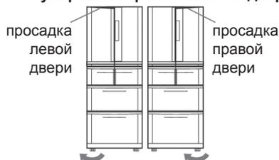
Если холодильник наклоняется налево, его можно выровнять посредством левой подножки регулировки уровня.
