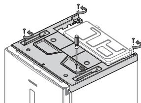
2. Снимите пластиковую крышку и отсоедините провода, подсоединеные к ней.
