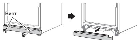
6. Вывинтите 3 болта, фиксирующие петлю, а затем вывинтите 3 болта с левой нижней стороны возле передней ножки, куда будет крепиться снятая петля.
