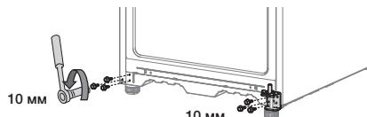
7. Вначале отсоедините шпиндель петли с помощью шестигранного ключа. Вывинтите болт, чтобы снять подставку, и переставьте шпиндель и подставку на другую сторону
