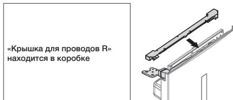
15. Снимите крышку ручки и вывинтите винты, а затем отсоедините заглушки и переместите ручку с левой на правую сторону дверцы (обязательно установите снятые заглушки на левую сторону).
