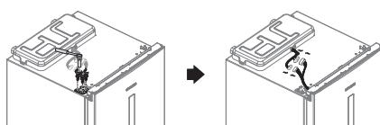
ПРЕДУПРЕЖДЕНИЕ Прежде чем отсоединять провода, обязательно отключите холодильник от электросети.
