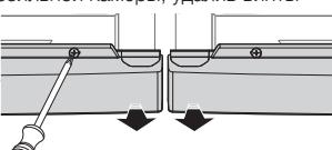
3. Выкрутите винты из обоих изделий, а после установки нижнего фиксатора верните их на место.
