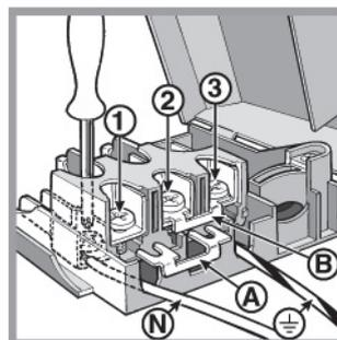
2. Разместите соединительную перемычку «А» (см. рис.) в соответствии с вышеуказанной схемой. Оборудование предназначено для однофазного подключения, 230 В: контакты клеммника 1, 2 и 3 соединены друг с другом; перемычка для контактов 4-5 расположена в нижней части клеммника.
