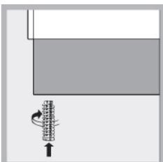
Плита снабжена регулируемыми ножками, которые служат для ее выравнивания. При необходимости, ножки вкручиваются в отверстия по углам основания плиты (см. рис.).
