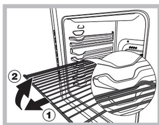
**ВНИМАНИЕ!** Духовой шкаф укомплектован системой блокировки решеток, позволяющей вынимать их из духовки не полностью (1).
