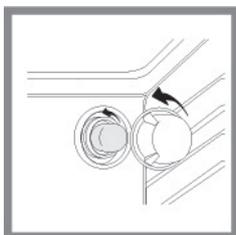
1. Отключите оборудования от электросети, затем снимите стеклянный плафон с патрона лампы (см. рис.).
