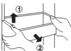
Чтобы извлечь **дверную полку** необходимо поднять ее кверху (1), держа за обе стороны, затем потянуть на себя (2). После такого как вы почистите **полку** установите ее обратно. Так же вы можете регулировать положение полки по высоте.
