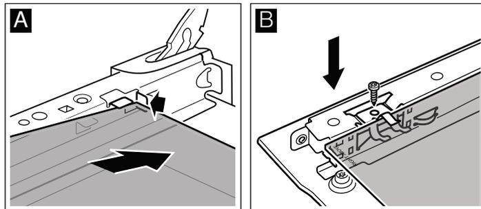
3. Наклоните верхнее стекло и вставьте его движением назад. Гладкая поверхность должна быть снаружи.
