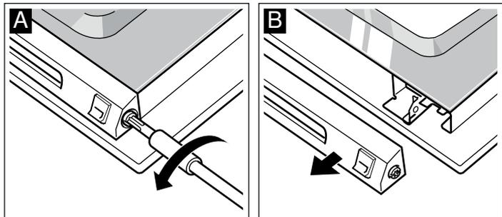
Проследите за тем, чтобы дверца духового шкафа не закрылась, пока панель будет снята. Внутреннее стекло может быть повреждено.
