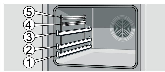
Принадлежности не опрокинутся, даже если их выдвинуть из духового шкафа примерно наполовину. Благодаря этому готовые блюда можно легко вынуть. С помощью выдвигных направляющих на уровнях 1, 2 и 3 можно выдвигать принадлежности на большее расстояние.
