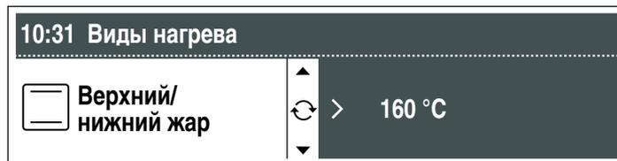
2. Перейдите к установке температуры кнопкой > и установите температуру поворотным переключателем.
