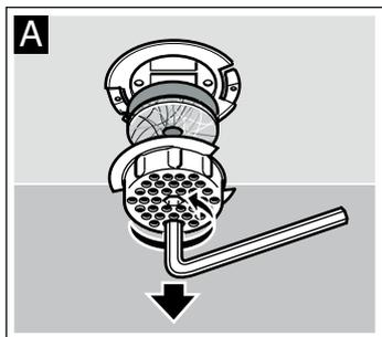
Корпус фильтра и тонкий однослойный фильтрующий элемент можно мыть моющим средством или в контейнере для столовых приборов в посудомоечной машине. Толстый фильтрующий элемент не подлежит очистке, так как при этом может быть повреждено покрытие.
