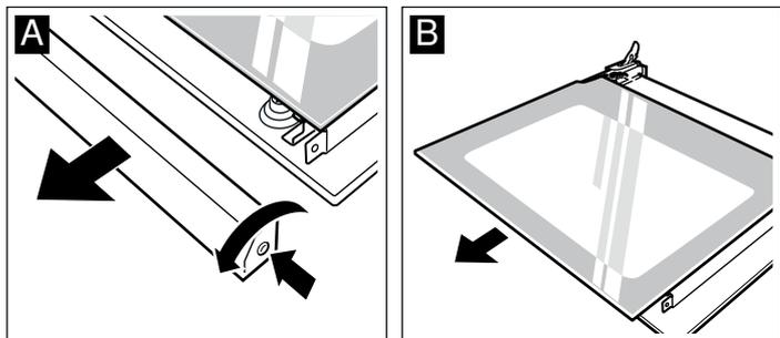
4. Отвинтите винты крепления левого и правого зажимов. Приподнимите стекло и отодвиньте от него крепления (рис. С). Выньте стекло.
