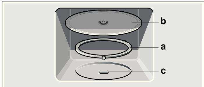
**Указание:** Используйте прибор со вставленной вращающейся подставкой. Проверьте, чтобы она была правильно зафиксирована. Вращающаяся подставка может вращаться как в левую, так и в правую сторону.
