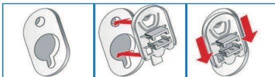
**i** Зафиксируйте заглушки путем нажатия на стопорные крючки.
