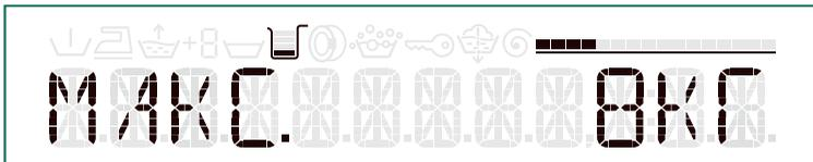
Участок дисплея показывает монитор загрузки для выбранной программы (напр., для программы Хлопок). Монитор загрузки выводится на дисплей при открывании люка или изменении количества белья.
