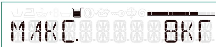
Участок дисплея показывает рекомендованную дозировку в зависимости от загруженного количества белья. Указание в % касается рекомендации изготовителя моющего средства.
