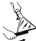
**ВНИМАНИЕ!!! В случае, если заблокируются сопла распылителя, следует отсоединить насадку от трубы и очистить (продуть) всасывающий канал или заменить сопло новым.**
