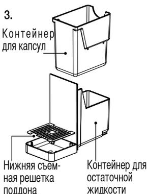
4. В случае необходимости, можно снять контейнер для остаточной воды. Для этого, отделите его от нижней части поддона (защёлкивающий замок).
