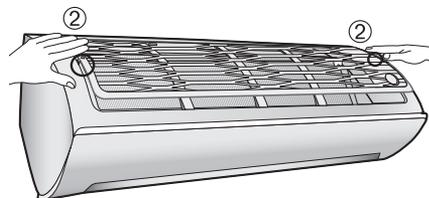
3. Слегка нажмите сверху на фильтр, чтобы надежно закрепить основной корпус. ③④⑤
