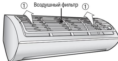
2. В обеих сторонах фильтра имеется по одному крючку, слегка надавите на поверхность воздушного фильтра, чтобы крючки зашли с основной корпус. ②
