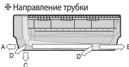
1. Определите положение отверстия для трубки и сливного шланга как показано на рисунке, и просверлите отверстие внутренним диаметром 65 мм так, чтобы оно слегка наклонялось вниз.
