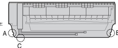
1. Вырежьте подходящую продавленную часть (A, B, C) на задней панели внутреннего блока, если вы подключаете эту трубку непосредственно с тыльной стороны.
