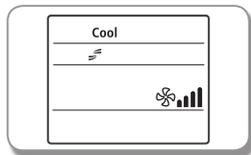
Для того, чтобы включить режим Fast, один раз нажмите на кнопку Fast/Comfort на вашем пульте дистанционного управления.
