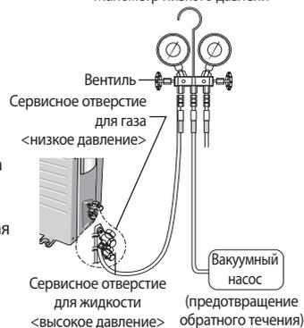
6. Установите золотник вентиля сервисного отверстия для жидкости и газа в открытое положение.
