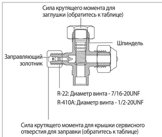
Деталь для проверки наружного блока
