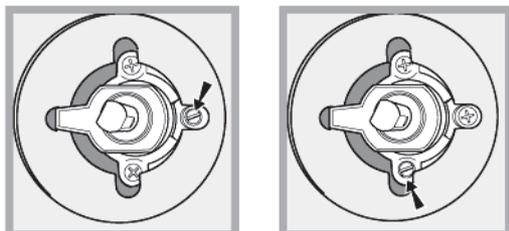
! В случае использования природного газа регулировочный винт следует ослабить, отвернув его против часовой стрелки.
