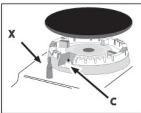
В моделях, имеющих устройство электронного зажигания\* (C), нажмите кнопку электронного зажигания, обозначенную символом
